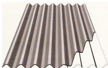
Joonis 1 – tugevdusriba paiknemine plaadis
